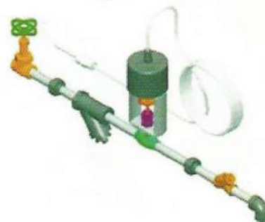
Equipo para pre calentamiento de Agua de Alimentación del Generador de Vapor
